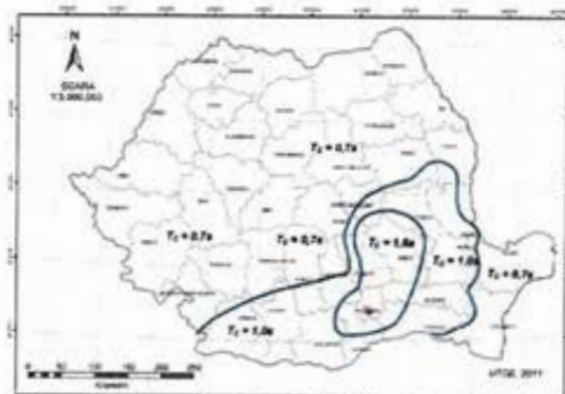
Figura 3.2 Zonarea seismică în funcție de perioada de control seismică T_c a spectrului de răspuns
