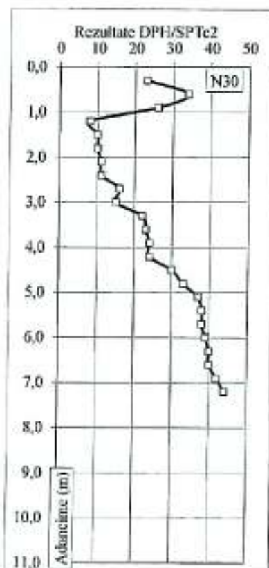
Prelucrare Date Penetrare Dinamica DPH/SPTc 2, Str. Brestei/Răului , Craiova (Referinta forajele F1 si P2)
