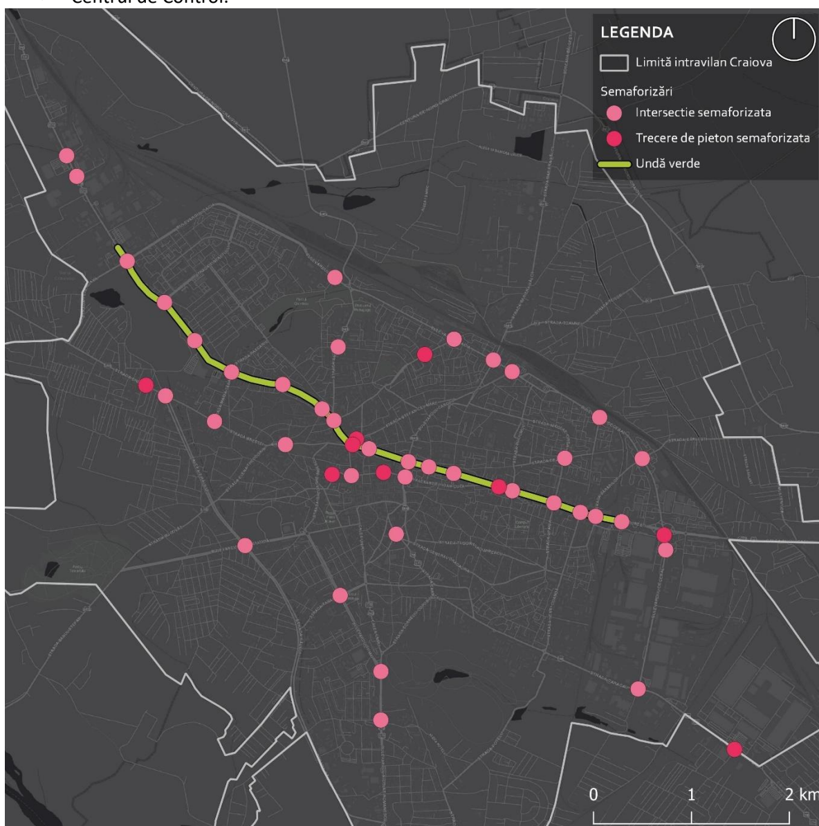
Figură 2-86 - Localizarea traseului de tramvai care beneficiază de prioritizarea de tip "undă verde"
