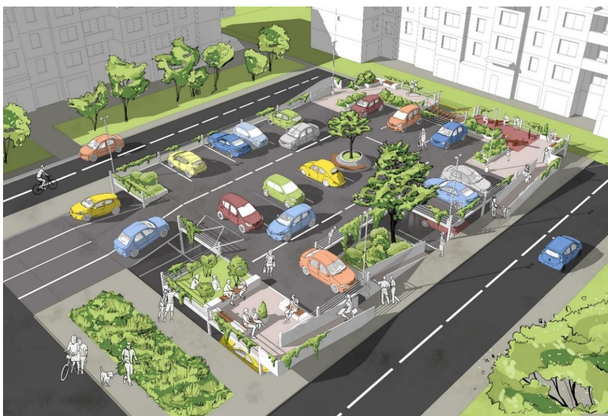
Figură 6-14 Mod de amenajare parcare 2 nivele cu nivelul superior axat pe locuri de parcare; Sursa: Portofoliu consultant
